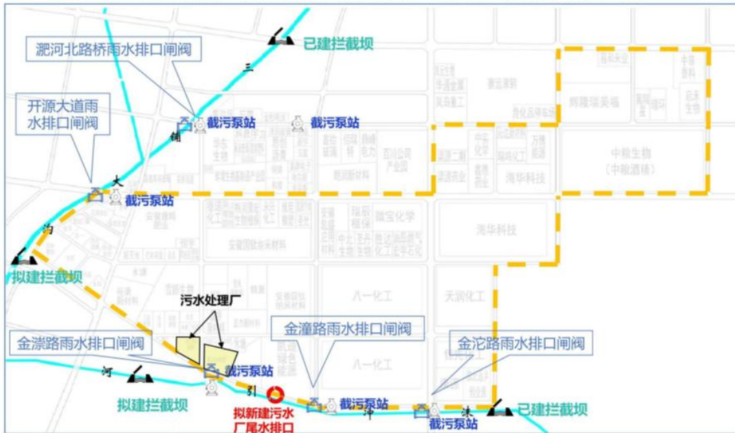
化工园区突发水环境事件三级防控体系-二级和三级防控措施位置图
